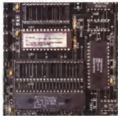
Un particolare della scheda madre in cui compare la ROM del BIOS AT compatibile ed il microprocessore Intel 80286.
